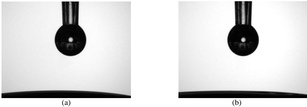
Figura 2: Imagen de una gota de agua depositada sobre la muestra: (a) Blastinizado-APQ y (b) Blastinizado, ambas con tratamiento alcalino y térmico.
