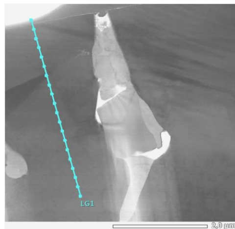
Figura 3. Lámina TEM de una partícula y análisis de composición química en profundidad usando EDS.
